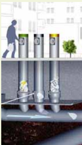
מהבית למרכז סילוק האשפה. מערכות פסולת פנאומטיות כמו זו שבתמונה מתאימות במיוחד לשימוש באזורים עירוניים עתיקים וצפופים
